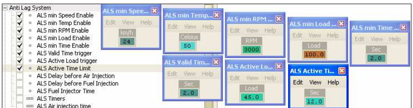
Figure 104: ALS TUNING, MINIMUM VALUE TRIGGERS
