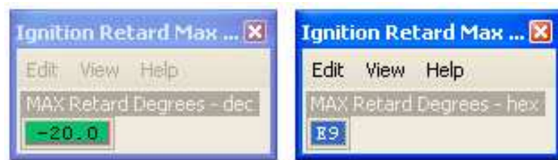
Figure 107: ALS TUNING, MAXIMUM IGNITION RETARD SETTING
