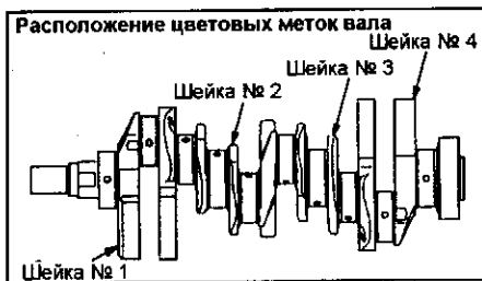
Серия 6G7 - Тип "1" маркировки вала.
